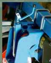
Macchinari regolazione profondità vegetativa / Crank/transmitting depth system control
