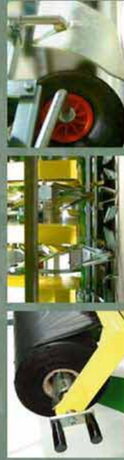
Supporto sabbia / Plastic water support - Distributore a tazze / Cup distributing system - Gruppo ribaltate film / Film covering system
