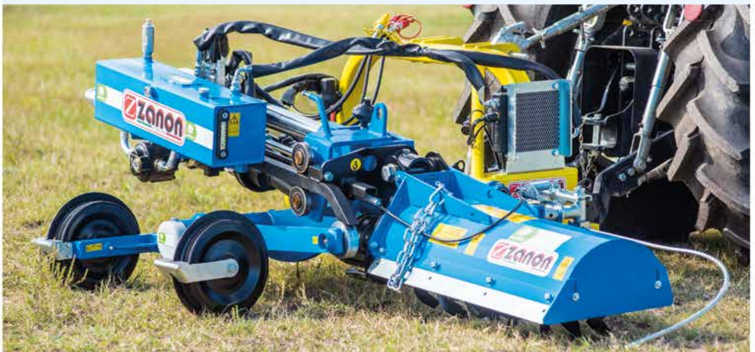
Hidraulikus munkamélység állítás a fej döntésével
