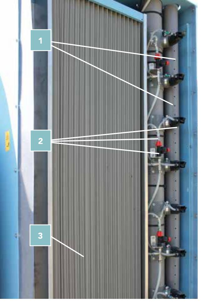
**1** Mikroperforált cső: erős légáram, amely a folyékony terméket a növényzethez juttatja. / Micro punched tube: a powerful jet of air which directs the delivered product toward the vegetation. / Tube perforé: puissant jet d'air qui dirige le produit distribué vers la végétation. / Schlauch mit Mikrolöchern: Starker Luftstrahl, welcher das Spritzmittel in den Bestand fördert. / Micro-tubo de dispositivo de que el uso de un potente chorro de aire dirige el producto entregado a la vegetación.
