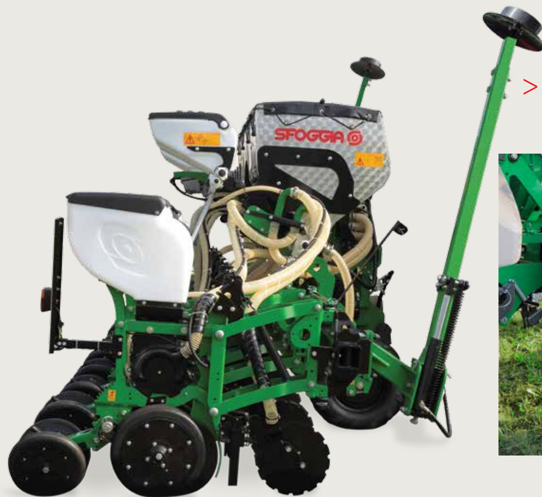
Elülső hajtó támasztókerekek, karos sebességállítóval
