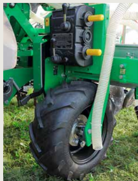
Elülső hajtó támasztókerekek, karos sebességállítóval
