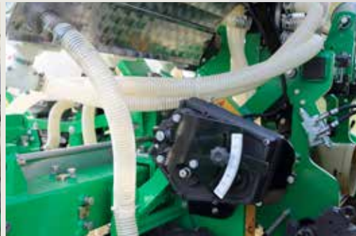
Fokozat mentes műtrágyaszóró hajtómű PLUS kivitelű vetőgépekre
