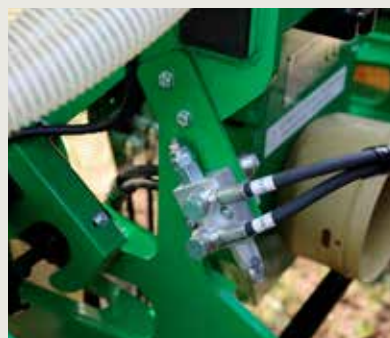
Nyomás kioldós szelep a vázon
