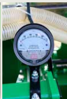
Nagy vákuummérő óra, a jobb ellenőrizhetőségért
