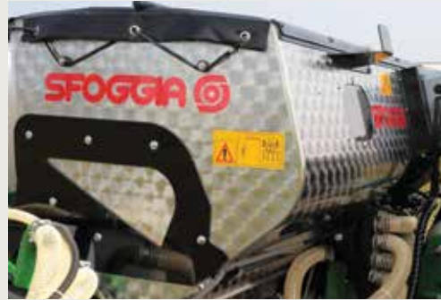
INOX műtrágyaszóró tartály, 900 liter mennyiség szabályzóval
