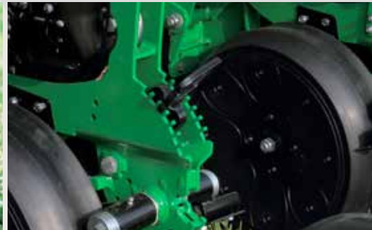
Gyors és könnyű vetésmélység állítás
